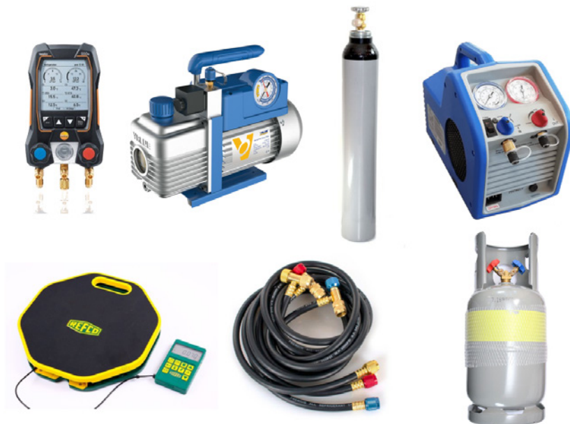
Fot. 1. Przykładowe elementy wyposażenia przedsiębiorstwa ubiegającego się o certyfikat dla przedsiębiorcy: oprawa manometryczna do prac z pompą ciepła (fot. Testo), pompa próżniowa (fot. Value), butla na ciekły azot do prób ciśnieniowych (fot. Milmet), stacja odzysku czynnika chłodniczego (fot. Promax/Bosch), waga elektroniczna (fot. Refco), węże serwisowe (fot. Black Diamond), butla dwuzaworowa do odzysku czynnika (fot. Milmet).
