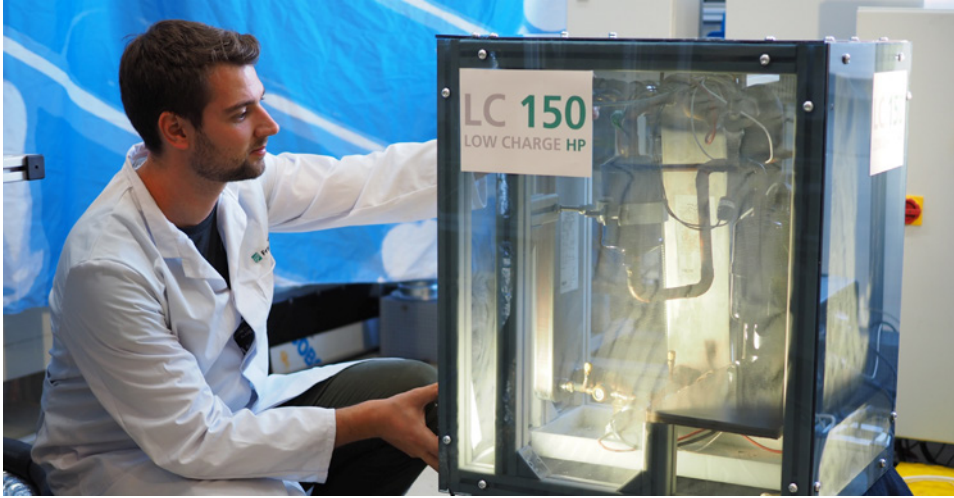
Fot. 4. Prace nad pompą ciepła na propan o napełnieniu do 150 g czynnika.
